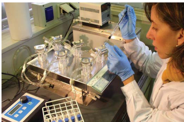
En los laboratorios del INTI-Química se dispone de un equipo de celdas de Franz para la realización de ensayos de difusión
