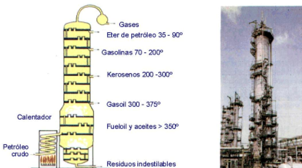
A medida que el gas asciende por la torre y se enfría, se condensan diferentes productos: *residuos sólidos*, *aceites pesados*, *gasóleos*, *queroseno*, *gasolinas* y *productos gaseosos*.
